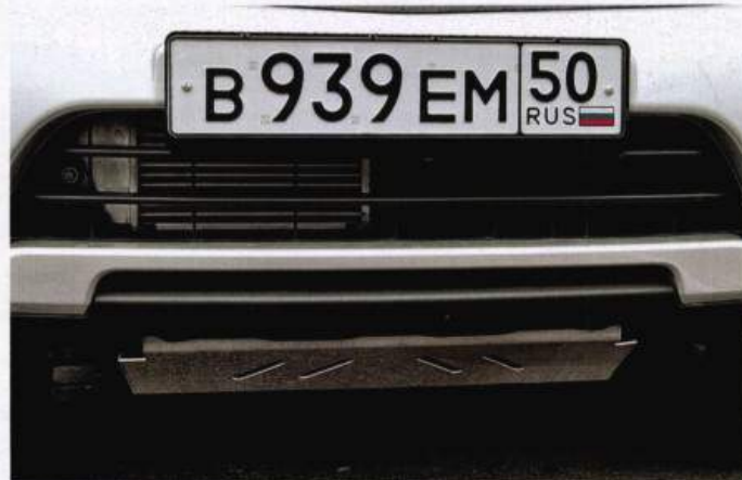
Если раньше интеркулер был хоть как-то защищен крупной решеткой в бампере, то после рестайлинга установка дополнительной сетки стала нужна как никогда
