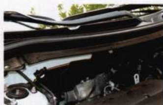
На капоте — усиленная шумоизоляция, а у моторного щита — дополнительный экран от гибрида Mitsubishi PHEV
