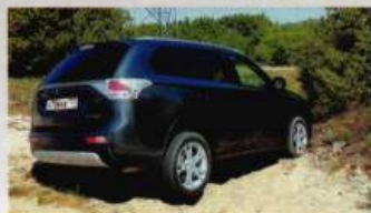
Оба передних колеса твердо стоят на земле, но Outlander застрял в песке почти на ровном месте: виноваты короткоходная подвеска, вариатор и отсутствие даже электронной имитации блокировок дифференциалов
