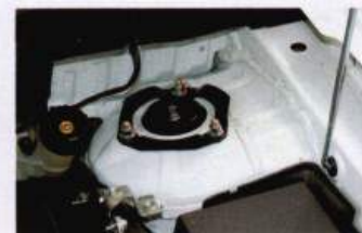
Опорные чашки стоек передней подвески усилены дополнительными накладками
