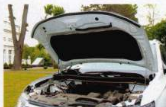
На капоте — усиленная шумоизоляция, а у моторного щита — дополнительный экран от гибрида Mitsubishi PHEV
